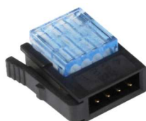
Ethernet Stecker Blau Anschlussstecker Ethernet 4-polig für die powerIO®-Line an der powerIO®-Box oder powerIO®-Start Unit. Bei powerIO®- Box im Lieferumfang enthalten. Werkzeuglose Montage (Schneidklemme / 0.25-0.50mm 2 )
